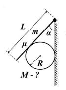
**2.** Однородный цилиндр радиусом R прижимается к вертикальной стене однородной пластиной длиной L и массой m, висящей на шарнире. Пластина составляет угол  $\alpha=60^\circ$  с вертикалью. Определите максимальную массу цилиндра, при которой возможно равновесие, если коэффициент трения между цилиндром и пластиной равен  $\mu$ , а трение между цилиндром и стеной так велико, что не допускает проскальзывания.
