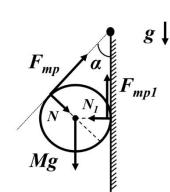
На цилиндр со стороны пластины и стены действуют силы реакции опоры N и  $N_1$ , силы трения  $F_{\rm Tp}$  и  $F_{\rm Tp1}$  и сила тяжести Mg. Требуется определить максимальную массу цилиндра, при которой возможно равновесие, поэтому
