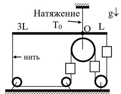
*Решение:* Введем обозначения:  $T_1$  – натяжение нити, которая прикреплена к левому по рисунку концу стержня,  $T_2$  – натяжение нити, прикрепленной к правому концу стержня,  $T_3$  натяжение нити, которая удерживает *большой* (по рисунку) блок.
