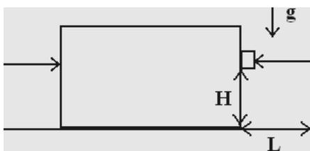
3. На высоте  $H = 11$  см от пола к ящику прижата шайба. Коэффициент трения между ними  $\mu = 0,3$ . На ящик действует горизонтальная сила  $F$ , равная силе, с которой давят на шайбу. Когда на шайбу перестают давить, система приходит в движение и при смещении ящика на  $L = 10$  см шайба достигает пола. Силы действующие на ящик неизменны. Найдите ускорение шайбы по горизонтали и вертикали. Ускорение свободного падения  $g = 9,8$  м/с<sup>2</sup>.
