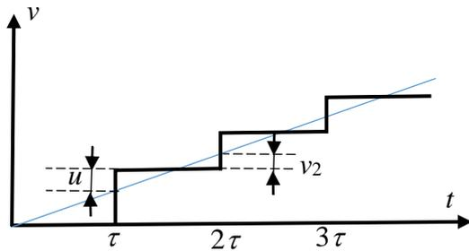
Через  $2\tau$  скорость ракеты будет  $v_{p2} = 2a\tau$ , измеренная ее скорость относительно дрона будет  $v_2 = a\tau - u$ . Из последнего соотношения находим ускорение  $a = (u + v_2) / \tau$  <2 балла>. Во всех интервалах времени между включениями двигателя дрона скорость ракеты относительно него в начале интервала  $v_n = -u$ , а в конце  $v_k = -u + a\tau = v_2$ .
