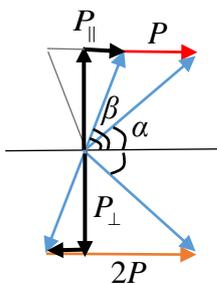
Пружинка передает частям тела равный по модулю и противоположный по направлению импульс, параллельный направлению ее оси. <2 балла>
