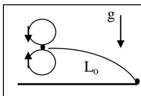
2. В устройстве для подачи теннисных мячей есть два одинаковых цилиндра, вращающихся с равной угловой скоростью. Мяч попадает между цилиндрами и, разогнавшись, вылетает по горизонтали. Дальность полёта равна  $L_0$ . Из-за повреждения механизма один из цилиндров стал вращаться вдвое медленнее. Какова теперь дальность полёта мяча  $L$ ? На участке вылета проскальзывания между поверхностями цилиндров и мяча нет. Влиянием воздуха на движение мяча пренебречь.
