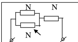
5. На каждом резисторе схемы выделяется одинаковая тепловая мощность  $N$ . Указанный на рис. резистор отсоединяют. Какая суммарная мощность будет выделяться при прежнем напряжении на входе схемы?
