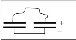
3. Пластины заряженных одинаковых плоских конденсаторов соединены, как показано на рисунке. Масса верхнего гибкого провода много меньше массы пластины. Исходно пластины закреплены. Верхнюю пластину левого конденсатора отпускают. Во сколько раз ускорение этой пластины перед столкновением её с нижней отличается от начального ускорения? Силу тяжести не учитывать, сопротивлением проводов пренебречь.
