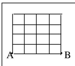
5. Сетка с квадратными ячейками спаяна из 10 медных проволочек длины  $L_0$  и диаметра  $d_0$ . Какой длины  $L$  нужно взять 10 медных проволочек с диаметром  $d = 2d_0$ , чтобы у спаянной из них сетки сопротивление между нижними углами осталось прежним? (Сопротивлением в местах спайки считать пренебрежимо малым.)
